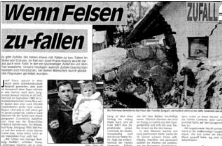
Abbildung 53: Effekt der Kerbwirkung an einspringenden Ecken bei Gewalteinwirkung. Der einzige Riß durch die Wand geht naturgemäß von der Ecke des Fensters aus. 242
